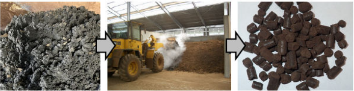
下水汚泥 超高温好気性発酵 汚泥肥料(ペレット)
